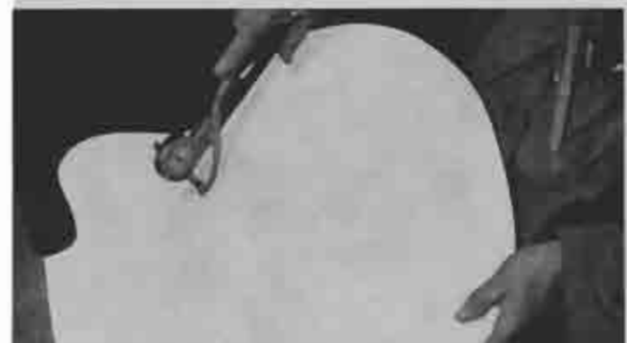
Mätning av lockets tjocklek.
